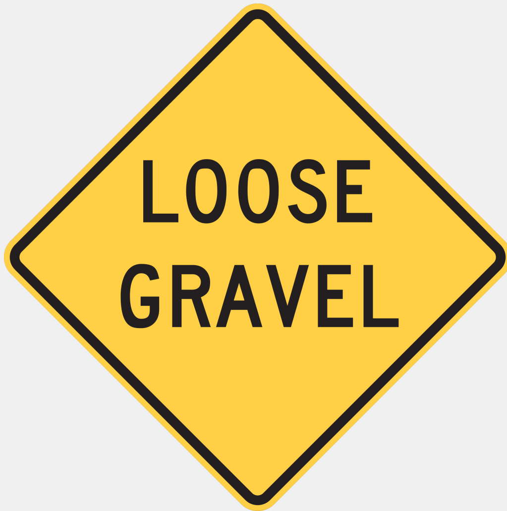
W8-7 Loose Gravel
